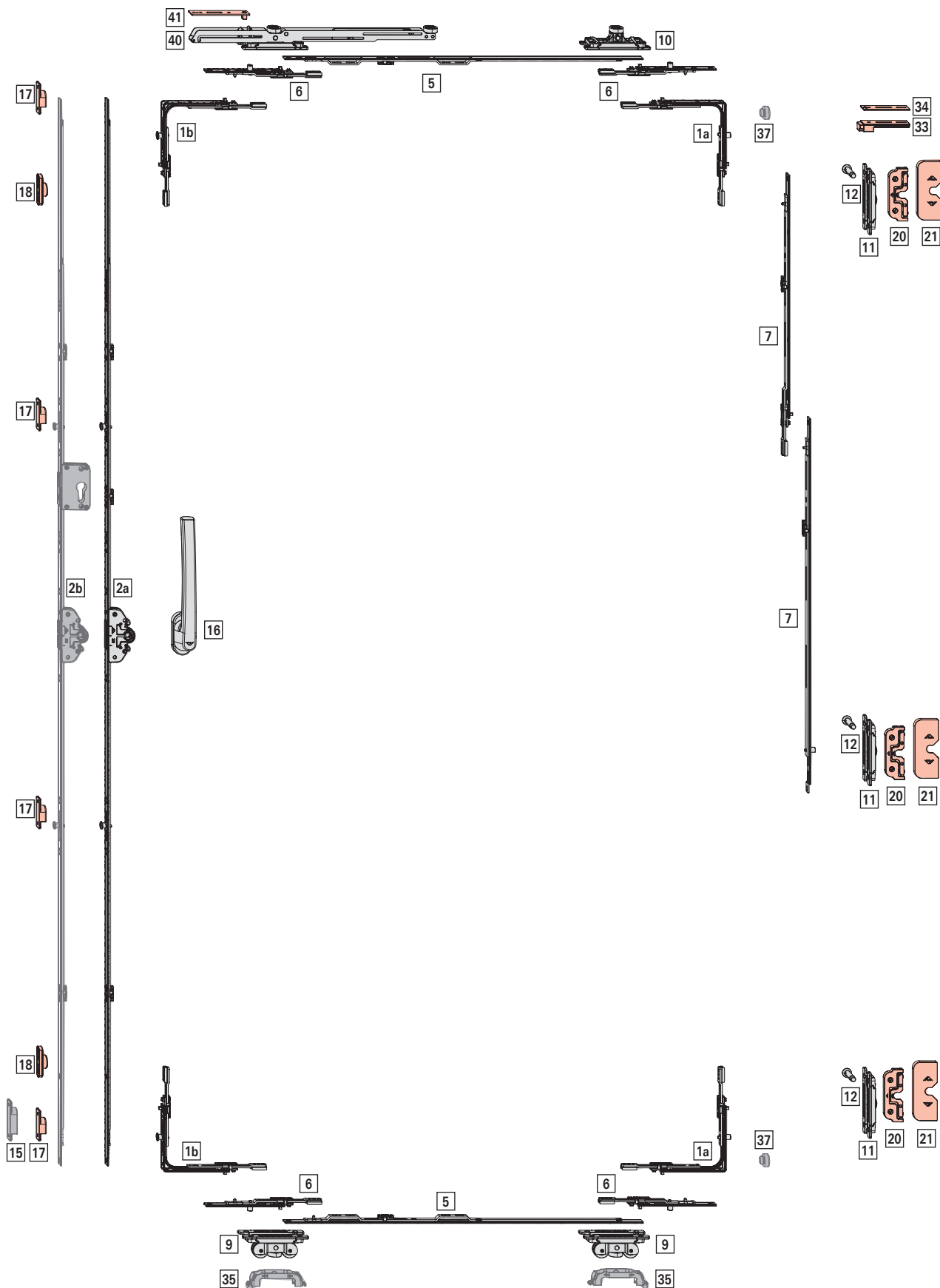
Илл. 3.1: на рис.: ПВХ, исполнение с левым открыванием согласно DIN; ШСФ 900 мм; ВСФ 1800 мм; запор DM 35
